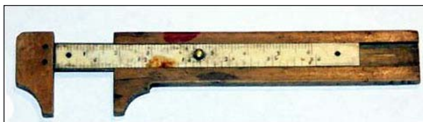
FIGURE 2 — Pied à coulisse XVIII e siècle, à double graduation. © Photo J. -P. Donzey (Wikipédia)
